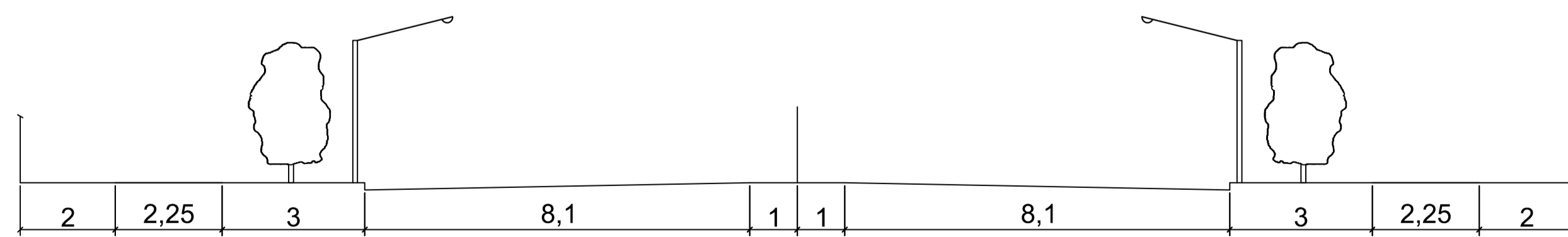
Поперечний профіль Брест-Литовське шосе М 1:100
